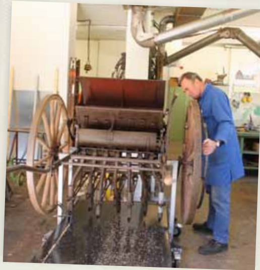
Neue Mitmach-Station fürs Agrarium: Die Drillmaschine, vom Freilichtmuseum selbst geplant und konstruiert.
